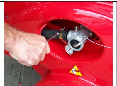
Überprüfen Sie die korrekte Lage und Funktion der mechanischen Abschaltung. Die Abschaltung muß die Antriebsbacke (Obere) bei Ankunft des Regnerwagens vom Exenter abheben.
