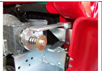
Verschrauben Sie die Radstützen mit dem Regnerwagen. Danach schrauben Sie den Schwinghebelregner auf den Regnerwagen.
