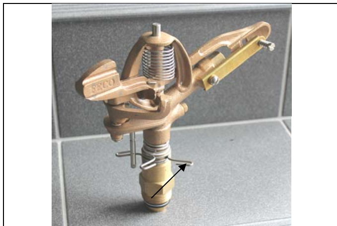
Zur Sektorvergrößerung die Spanne in Pfeilrichtung drücken
