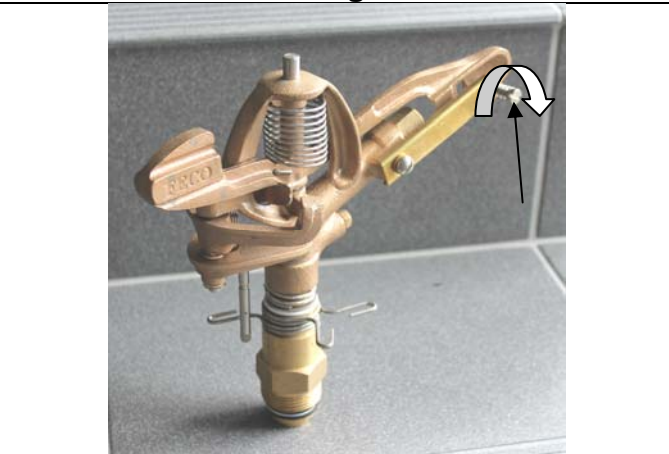
Zur Wurfweitenverkürzung oder Strahlstörung die Schraube im Uhrzeigersinn eindrehen
