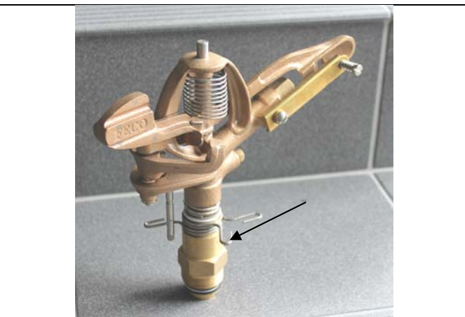
Zur Sektorverkleinerung die Spanne in Pfeilrichtung drücken
