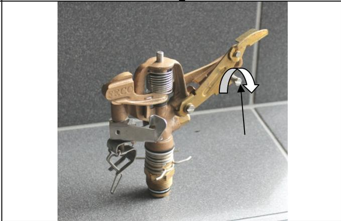
**Zur Wurfweitenverkürzung oder Strahlstörung die Schraube im Uhrzeigersinn eindrehen**
