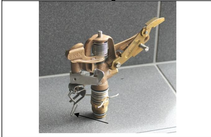
**Zur Umschaltung auf Vollkreisbetrieb die Anschlagfeder nach Oben klappen**
