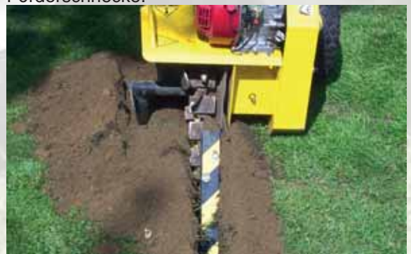
Die Fräsgeschwindigkeit beträgt ca. ein bis zwei Meter pro Minute.
