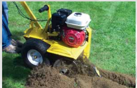
Seitlicher Erdbodenauswurf durch Förderschnecke.
