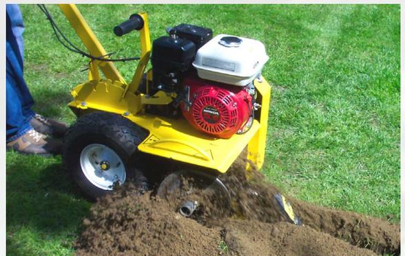
Seitlicher Erdbodenauswurf durch Förderschnecke.
