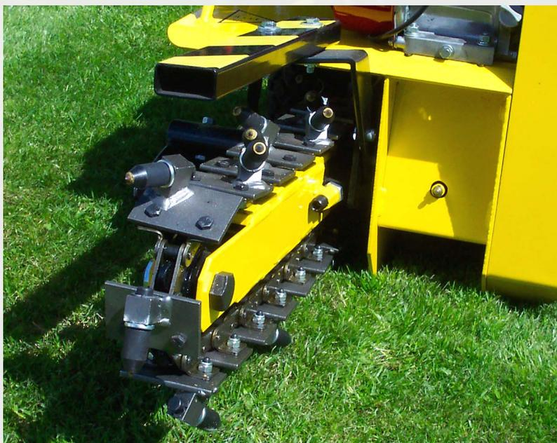
Die Fräskette ist bestückt mit 18 Spezialzähnen aus gehärtetem Kohlenstoff. Die Grabezähne sind in unregelmäßiger Richtung angebracht, so daß es möglich ist, Steine von unterschiedlicher Größe mit herauszugraben.
