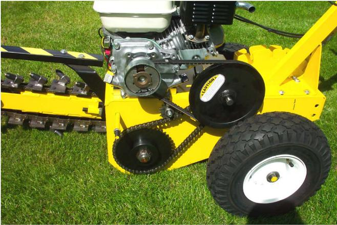
Der Fräskettenantrieb erfolgt über eine Rutschkupplung, die mit dem Motor verbunden ist sowie über einen Keilriemen. Durch diese Antriebskombination wird ein gefahrloses Fräsen gewährleistet und die Maschine geschont.
