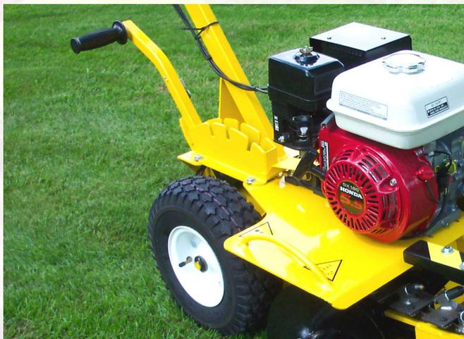
Die Grabentiefe wird von einem einzigen Hebel aus reguliert. Drei Frästiefen stehen zur Auswahl: 15 cm, 25 cm und 35 cm (Option 30 cm, 40 cm, 50 cm).
