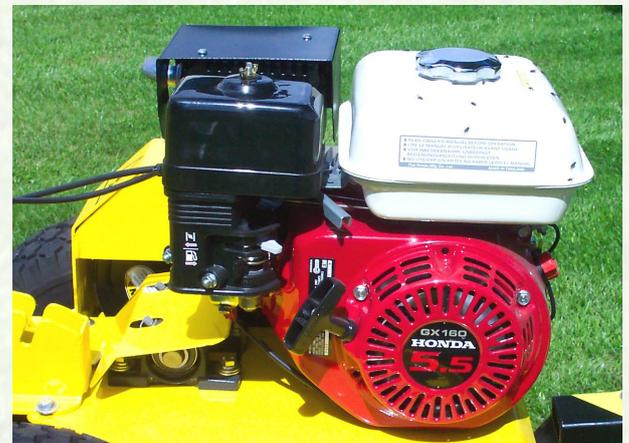
Die Maschine wird mit einem 5,5 PS Honda-Motor geliefert.
